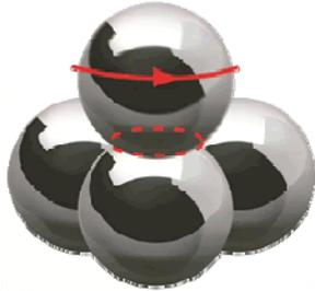
**4-Kugel-Verschleiß: Stahl-auf-Stahl-Test zur Ermittlung, wie gut ein Fett vor Verschleiß schützt**
